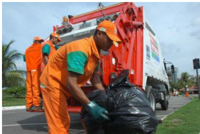
Figura 8: Caminhão compactador utilizado na coleta de resíduos sólidos urbanos.
