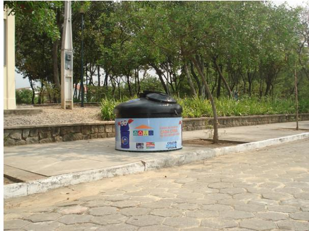
**Figura 7:** Exemplar de contentor semienterrado (tipo Molok) para coleta seletiva.
