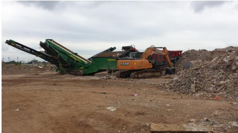
**Figura 20:** Equipamentos de beneficiamento de RCC da Natureza Viva.
