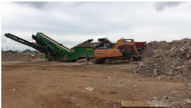
**Figura 126:** Equipamentos de beneficiamento de RCC da Natureza Viva.
