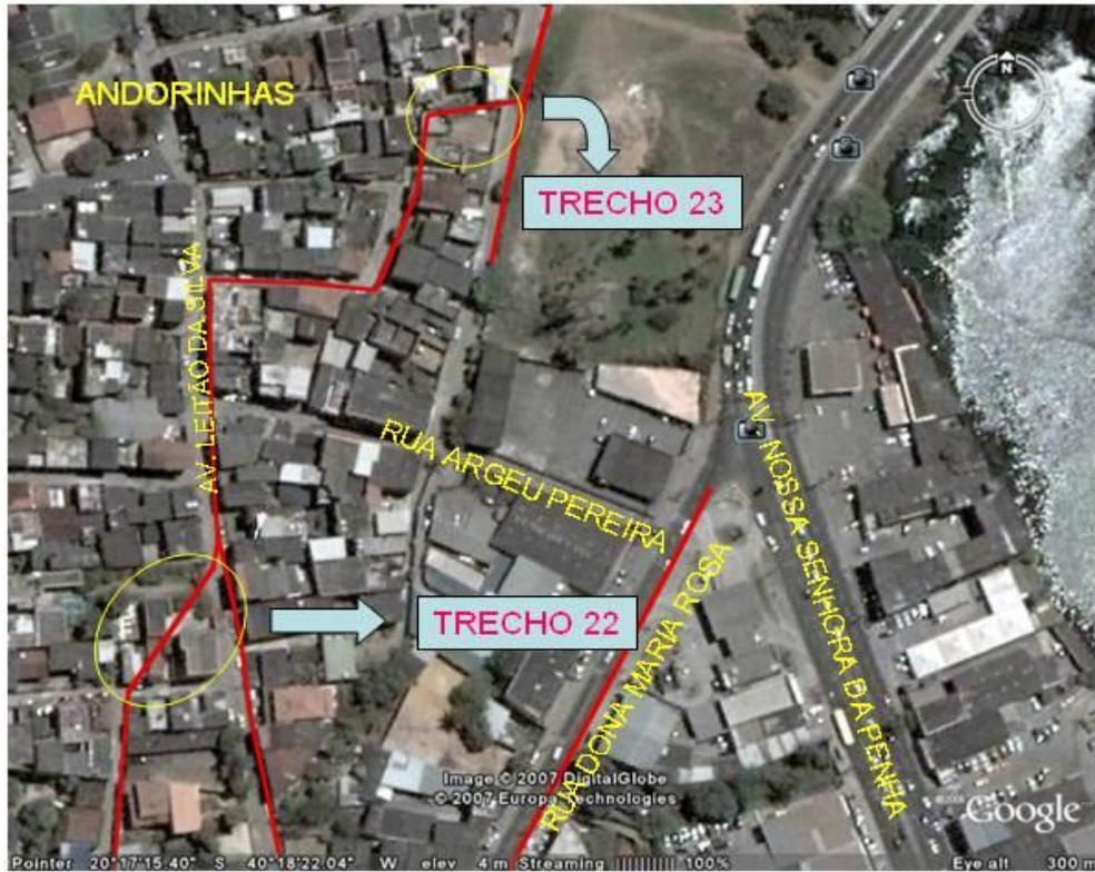
**Figura 119:** Edificações sobre a rede de drenagem. Trechos 23 e 22.
