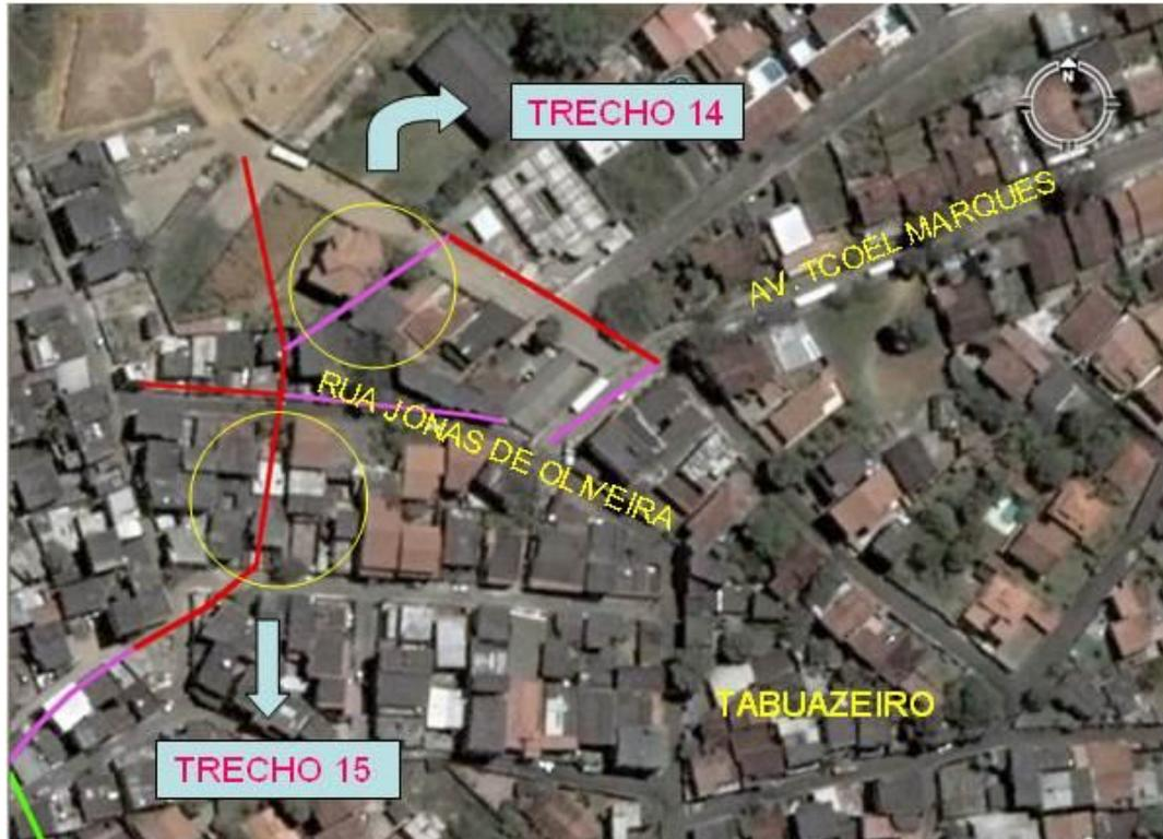
Figura 115: Edificações sobre a rede de drenagem. Trechos 14 e 15.
