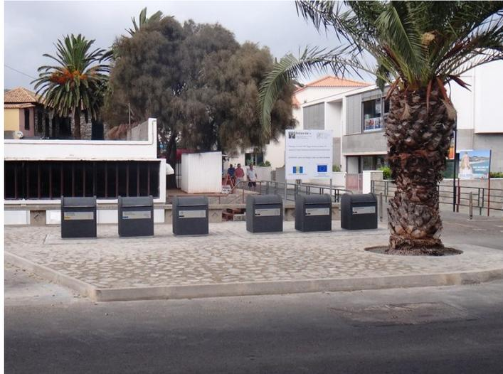
**Figura 86:** Contentores enterrados sob passeio público. Fonte: Águas e Resíduos da Madeira S.A, 2014.
